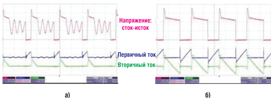
Рис. 2. Осциллограммы напряжения и тока в обратноходовых преобразователях
