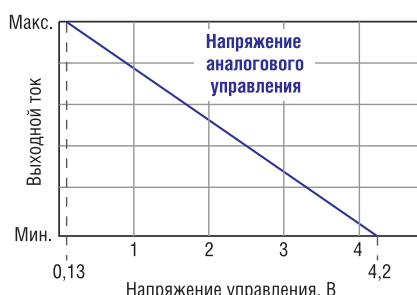
Рис. 5. График зависимости выходного тока драйвера от уровня управляющего напряжения при аналоговом управлении (см. рис. 4, а)
