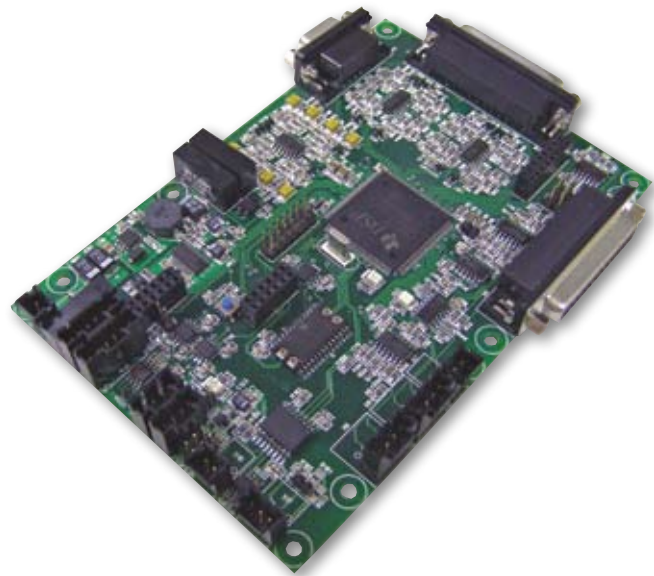
Рис. 6. Контроллер МК19.1 на базе TMS320F28335
