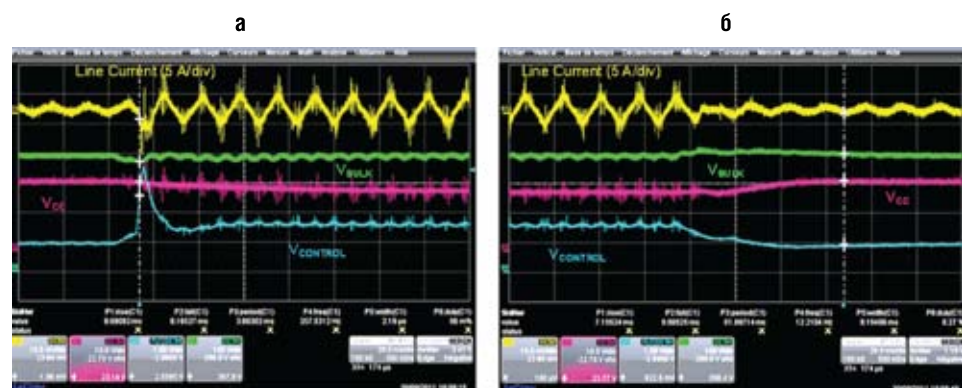
Рис. 9. Осциллограммы работы повышающего преобразователя, иллюстрирующие функцию компенсации скачкообразного изменения нагрузки: а) – ток нагрузки скачкообразно увеличивается; б) – ток нагрузки скачкообразно уменьшается
