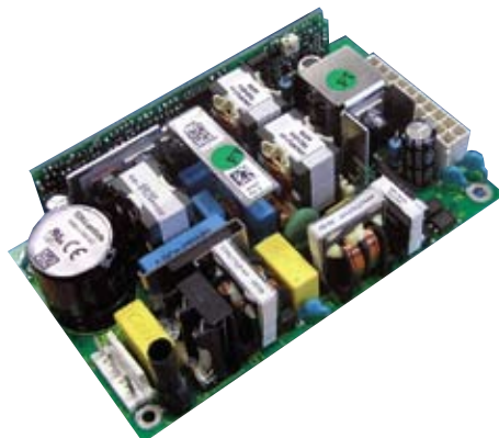
Рис. 2. Новый источник питания NVM175 для медицинского оборудования типа B и BF
