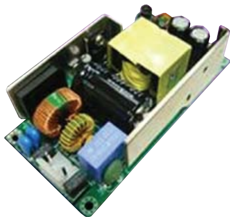
Рис. 4. Новый источник питания CSS65 для медицинского оборудования типа В
