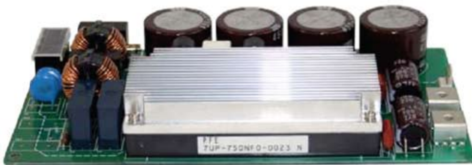
Рис. 7. Источник питания на основе модуля PFE с подключенным входным фильтром, внешними конденсаторами, выходным фильтром и установленным на модуль радиатором
