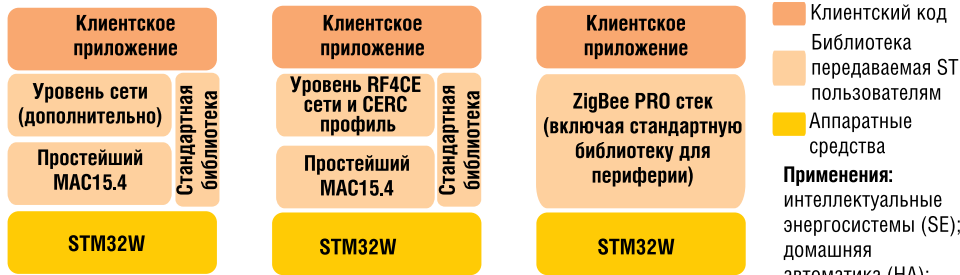
Рис. 2. Использование библиотеки ST ZigBee Pro
