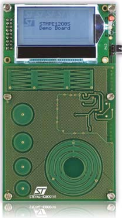
Рис. 1. Отладочная плата сенсорной клавиатуры STEVAL-ICB001V1
