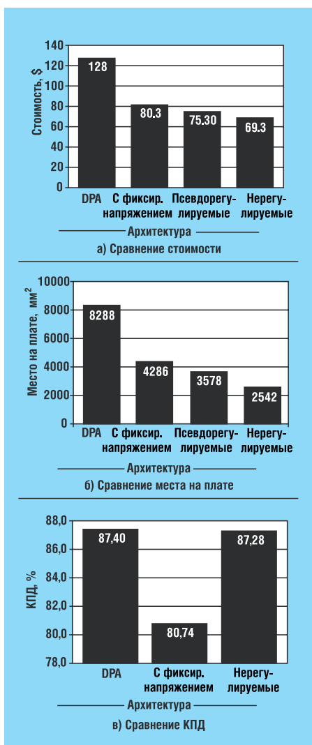
Рис. 5. Сравнение архитектур. (а) сравнение стоимости (б) сравнение занимаемого на плате места (в) сравнение КПД систем
