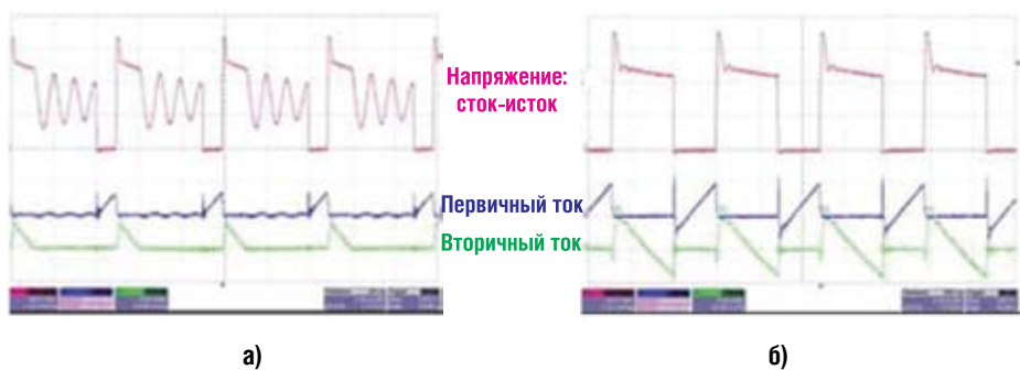
Рис. 2. Осциллограммы напряжения и тока в обратноходовых преобразователях
