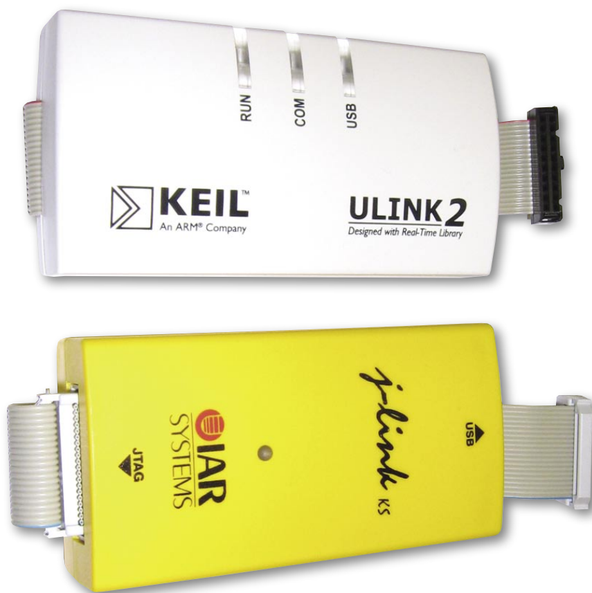
Рис. 2. Популярные JTAG-эмуляторы J-LINK и ULINK2
