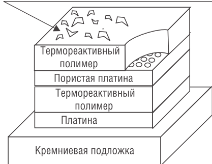
Рис. 1. Структура датчика влажности
