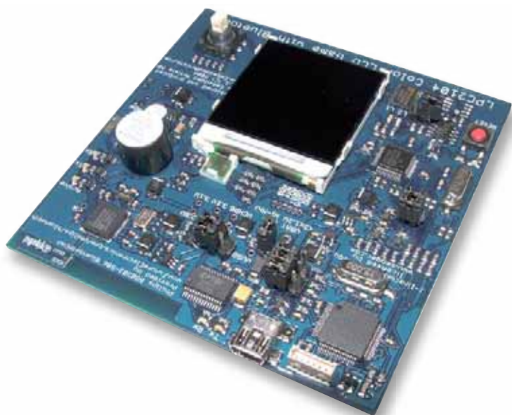
Рис. 1. Внешний вид отладочной платы EA-PRO-003
